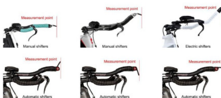
Figure 39 : Points de mesure de la distance horizontale depuis l'axe du boîtier de pédalier
